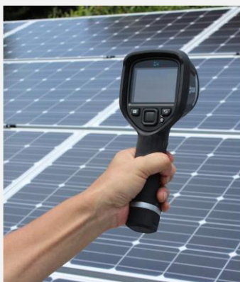
④ サーモグラフィによる発熱測定
